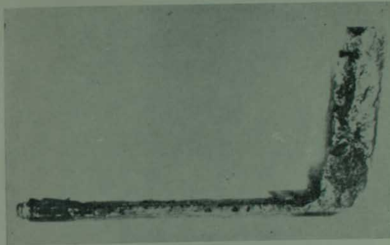
Aspectul suprafețelor de rupere din zona de racordare a tălpii inferioare cu peretele înclinat din traversa dansantă nr. 1355.
