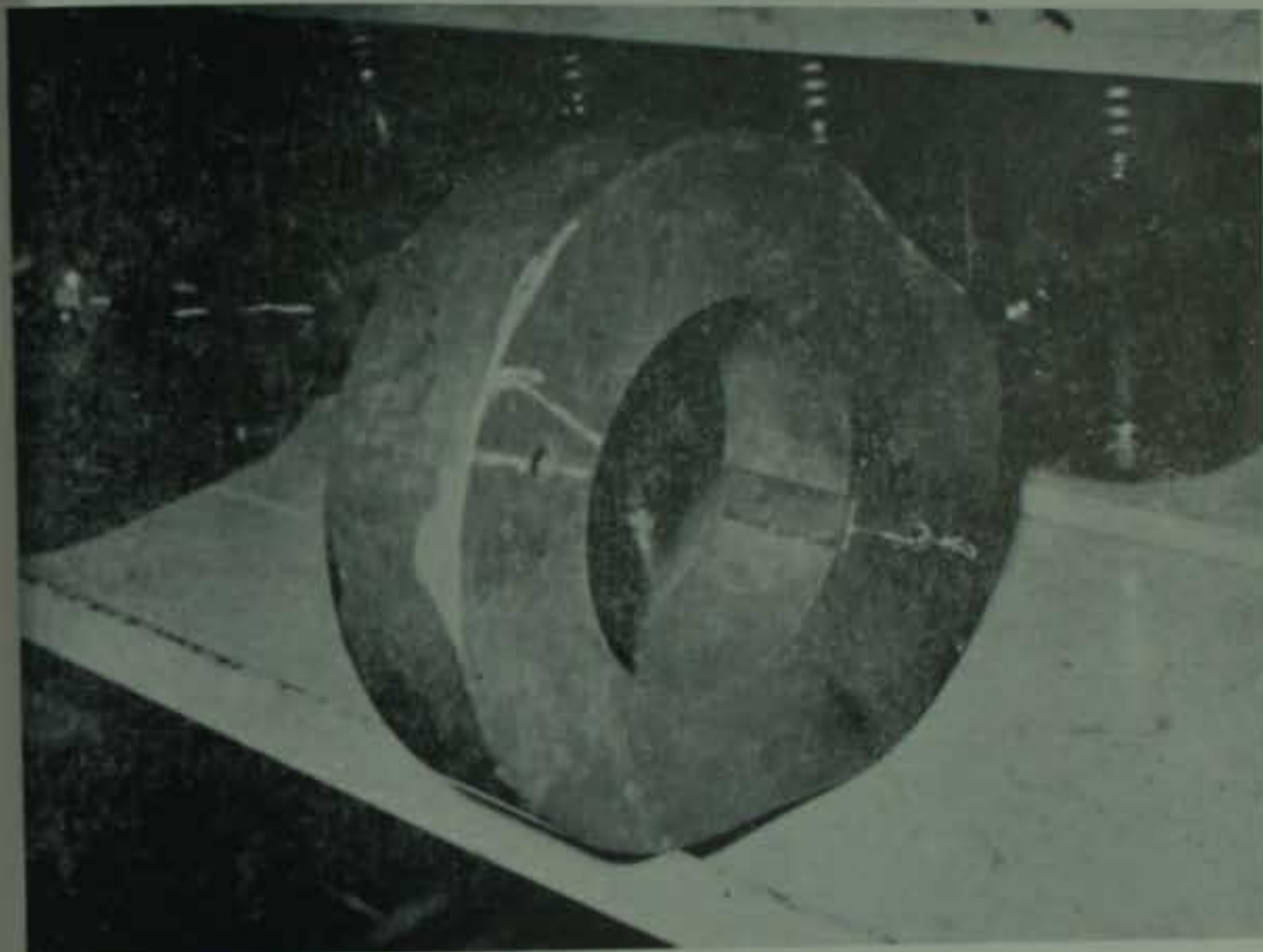
Porțiuni din camele vasului distruse ca urmare a unei greșite proiectări a materialelor.
